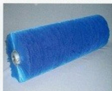
Manejamos una gran diversidad de fibras y núcleos con los que se puede fabricar este tipo de cepillos y sus dimensiones pueden ser desde 1" de diámetro hasta 32" de diámetro y en un largo desde 1/2" hasta 3 mts según sea la aplicación.
